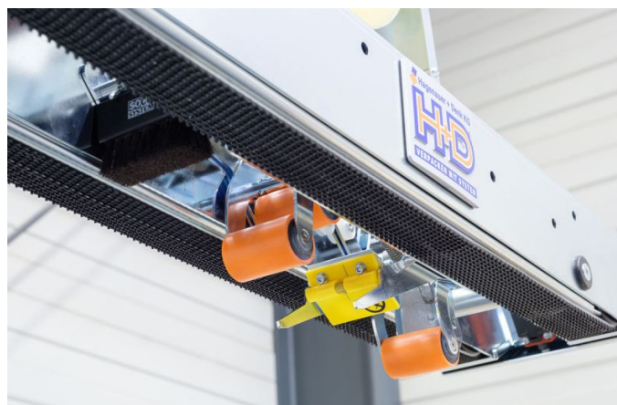
Robuste, federnde Doppel-Antriebe garantieren einen zuverlässigen Kartontransport.
