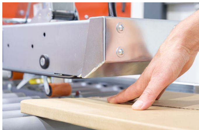
Kontaktplatte im Bandedinlauf für höchste Arbeitssicherheit.
