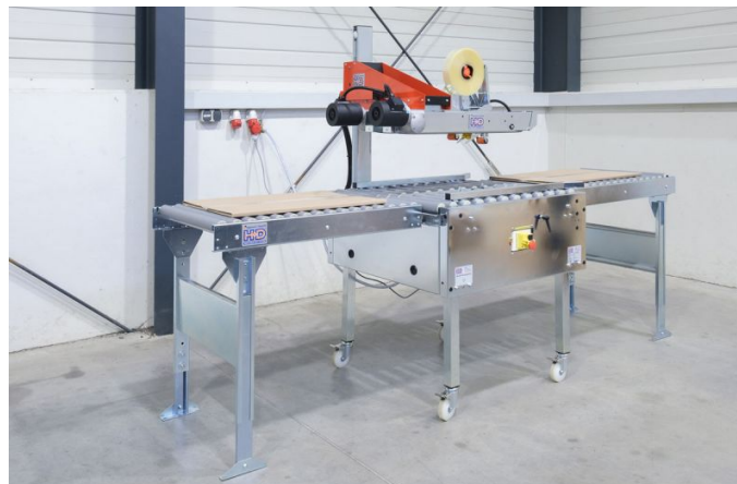
Einfache Umstellung von Kartonbreite und -höhe über Klemmhebel.
