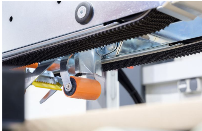
Der Klebeband-Dispenser kann anstelle des Bürstensystems auch unten eingebaut werden.
