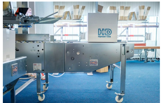
Einfache Montage des halbautomatischen Kartonaufrichters vor einen Kartonverschleißer
