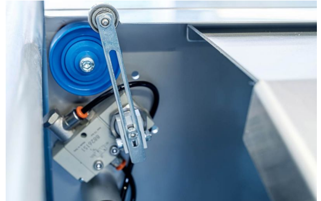
Öffnen der Faltheile über Rollenschalter im Auslauf
