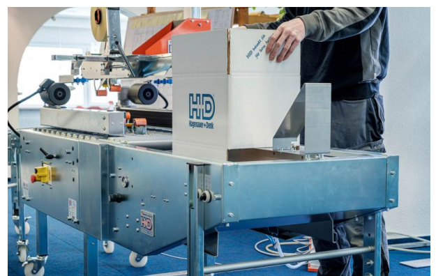
Nach dem Faltvorgang wird der Karton mit Klebeband verschlossen
