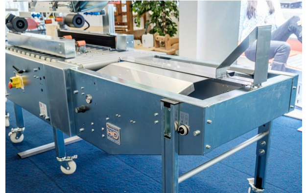
Pneumatische Faltbleche schlagen die Bodenlaschen ein und fixieren den Karton
