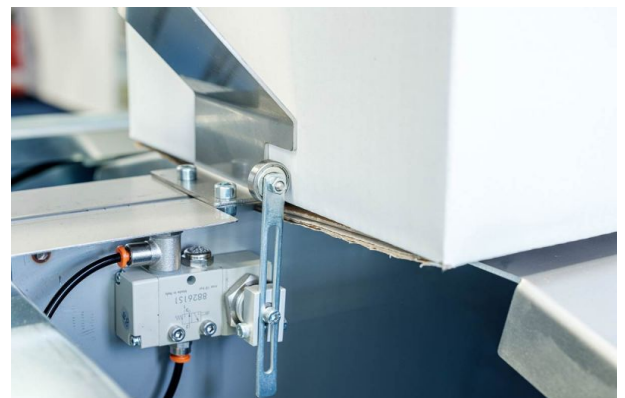
Aktivierung des Faltmechanismus über Rollenschalter
