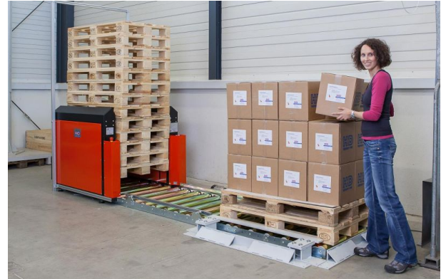
Aufdoppeln von Paletten in einem Hygienebereich
