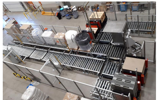
4 Palettenmagazine mit Palettenwechsel-Station in einem autonomen Palettenlager
