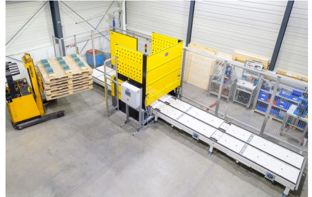
Vollautomatisches Palettenmagazin in Überbreite mit Kettenförderern
