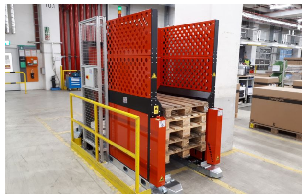
Rückseitige Zuführung von Einzel-Paletten, Aufstapeln auf der Vorderseite
