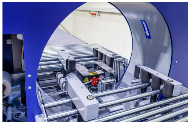
Produkteinzug mit automatischer Formateinstellung.
