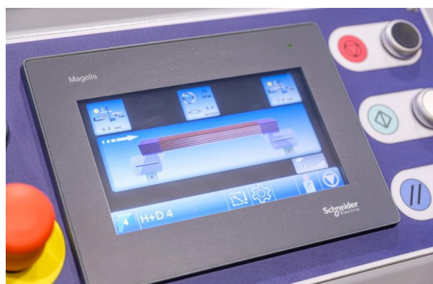
Animiertes Farb-Touch-Display für die individuelle Programmierung der Wickelrezepte.
