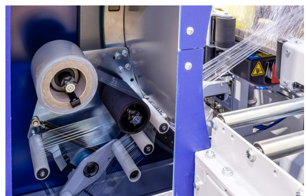
Folienwagen mit Vordehnsystem und Tänzerwalze für optimierten Folienverbrauch.
