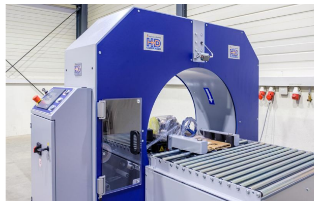
Die Zu- und Abführrollbahn ist Bestandteil des Horizontalwicklers.
