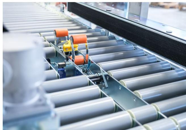
Automatischer Bodenverschluss im Kartondurchlauf
