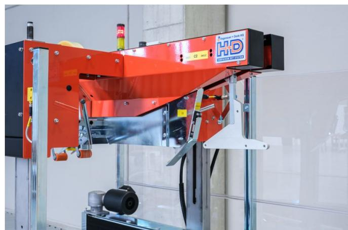
Steigeinheit auf Doppelsäule mit Klappeneinschlag und oberer Klebeeinheit
