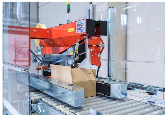
Klappeneinschlag und Klebeband-Verschluss in einer Maschine
