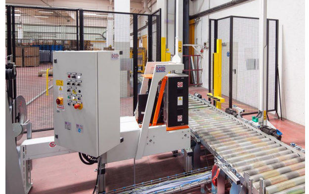
Vollautomatische Palettenumreifung mit seitlich verfahrbarem Schweißkopf.
