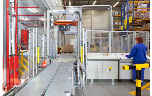
Vollautomatische Palettenumreifung mit integriertem Drehteller für 4-fach-Umreifung.
