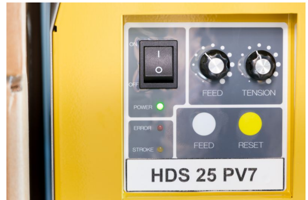
Flexible Einstellung von Bandvorschub und Bandspannung
