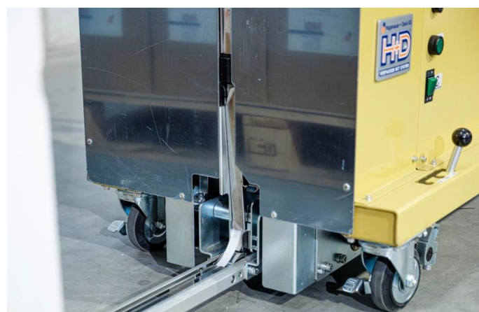
Zuverlässiger Bandtransport unter der Palette durch Klappensystem
