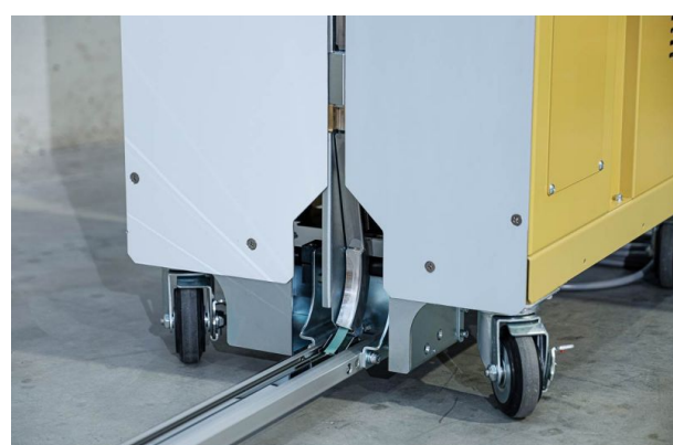
Niedriger Schweißkopf für Paletten schon ab 360 mm Höhe
