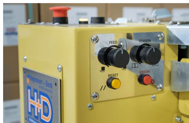
Flexible Einstellung der gewünschten Bandspannung
