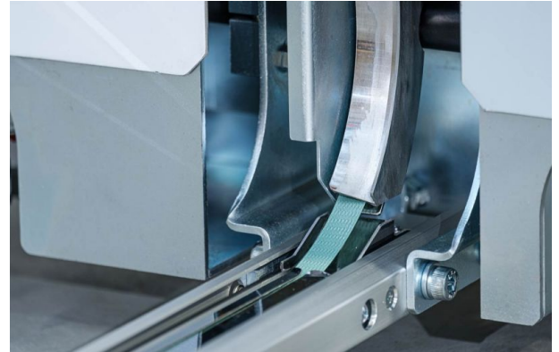
Zuverlässiger Bandtransport durch Klappensystem
