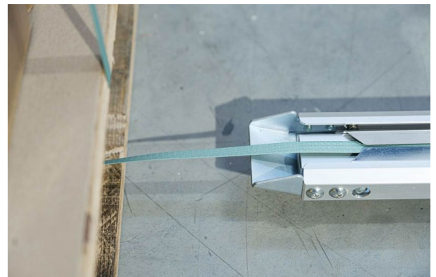
Universal-Lanze für alle Palettentypen
