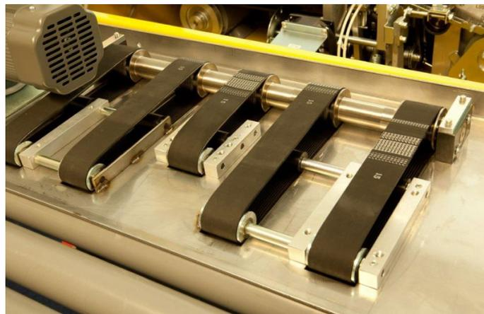
Mittelantrieb sorgt für zuverlässigen Transport von Kleinstpackstücken.
