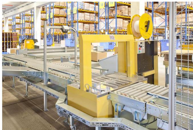
Vollautomatische Umreifungsmaschine HDS-9LA in einer Verpackungslinie
