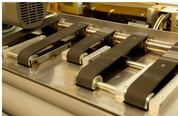
Sicherer Produkttransport durch bewährtes Rippenprofil.
