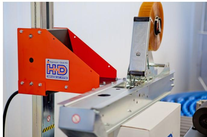
Der obere Klebebanddispenser senkt sich auf den Karton ab und sorgt für einen sicheren Klebebandverschluss
