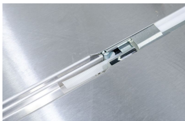
Das Umreifungsband wird geschützt unter dem Karton durchgeführt.
