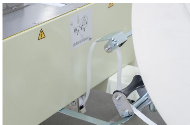
Leichtes Einfädeln des Umreifungsbands bei Rollenwechsel.
