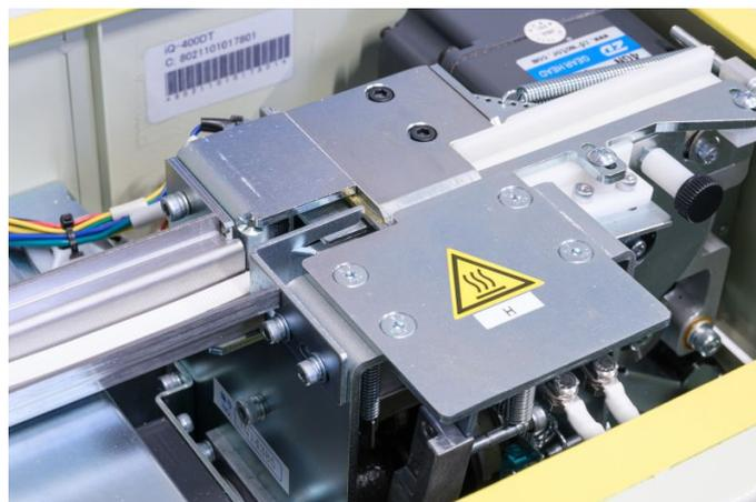
Der kleine Schweißkopf ermöglicht das Umreifen von Produkten schon ab 100 mm Breite.
