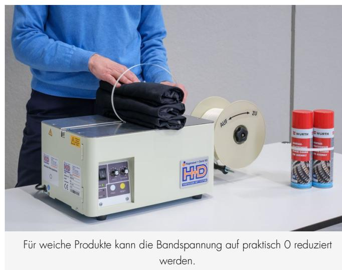
Für weiche Produkte kann die Bandspannung auf praktisch 0 reduziert werden.
