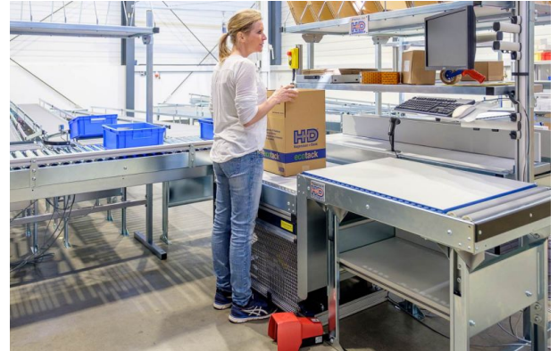
Viel Fußfreiheit unter dem Hubtisch für bessere Ergonomie.
