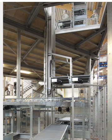
Schlanke, platzsparende Säulenkonstruktion aus Aluminium-Profilen.
