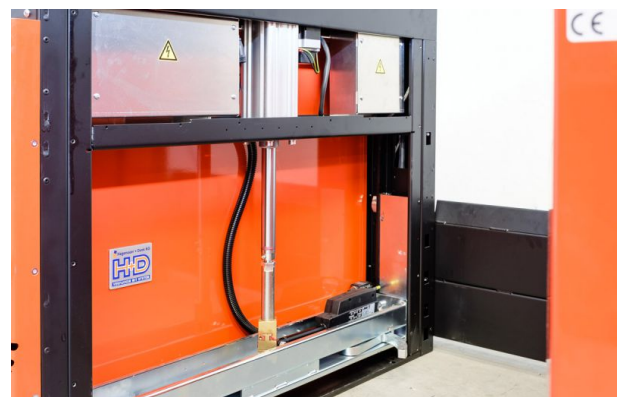
Die Hub- und Senkbewegung erfolgt über Spindelantriebe
