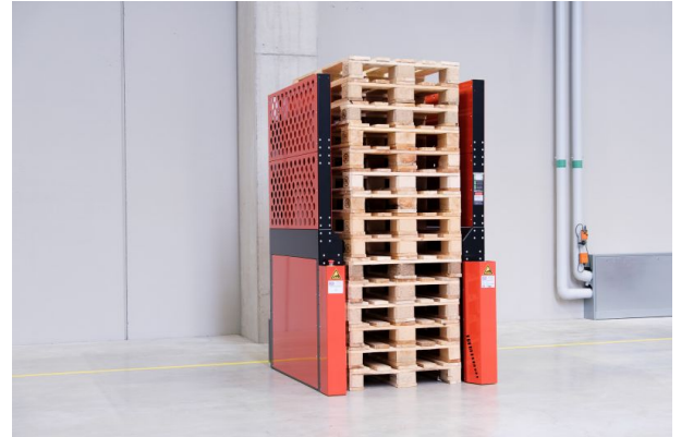
Das Palettenmagazin Elektro arbeitet rein elektrisch - ohne Druckluft
