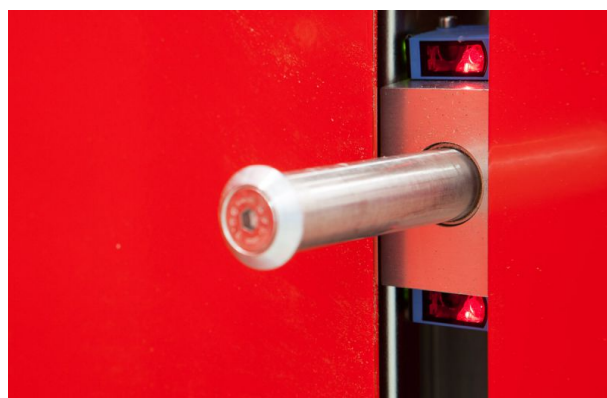
Sensorüberwachte Hebebolzen für das Auf- und Abstapeln von 1-5 Paletten
