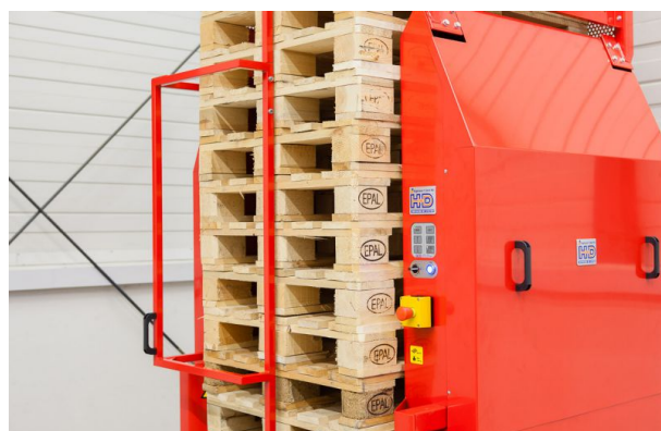
Schwenkbare Schutzür ist Pflicht bei einer Stapelhöhe von 24 Paletten
