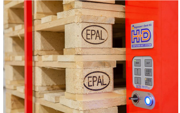
Bedienelemente für die Auf- und Abstapelfunktionen inkl. Automatikbetrieb
