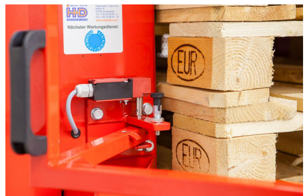
Sicherheitsschalter löst beim Öffnen der Schutztür aus
