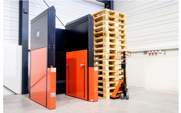
Das Palettenmagazin fasst bis zu 16 Paletten. Max. 5 Paletten können ein- oder ausgelagert werden.
