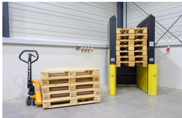
Gleichzeitige Entnahme von 5 Paletten aus dem Palettenmagazin
