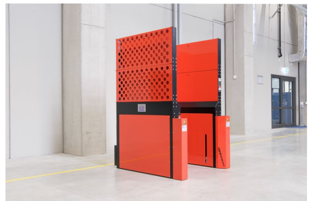
Die Seitenwände bieten Schutz vor Kippen und Eingreifen
