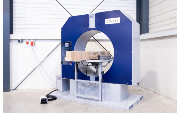
Horizontal-Stretchwickler zum Bänderolieren von Langgut.
