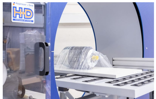
Horizontal-Stretchwickler zur Spiralwicklung von Ware auf Trägern.
