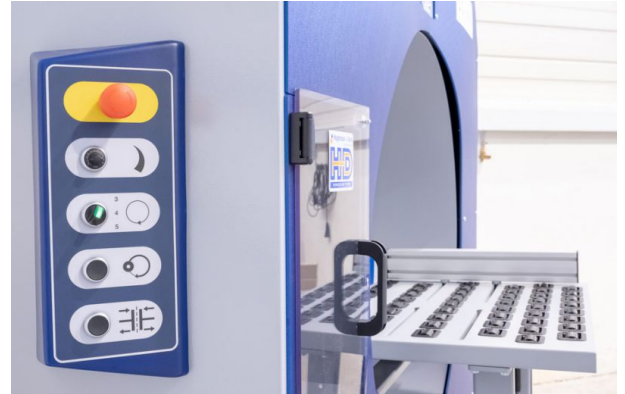
Rotationsgeschwindigkeit und Anzahl Wicklungen einstellen.
