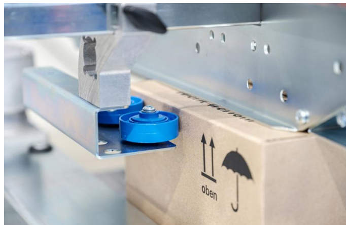
Anpress-Röllchen bringen überfüllte Kartons in Form.
