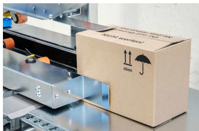
Führungsbleche für geraden Produkteinzug und faltenfreie Verklebung.
