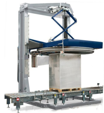
Ein Pantograph (Andruckteller) stabilisiert das Ladegut während des Wickelprozesses.
