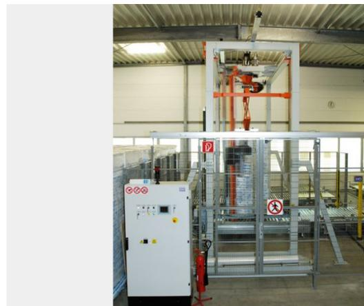
Dreharm-Wickler in Maxi-Höhe und Pantograph (Andruckteller).
