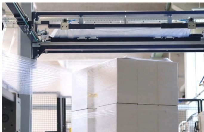
Das Abziehen der Deckblatts erfolgt bereits während des Wickelprozesses
