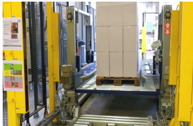
Eine Palette wird mittels Hubstation auf Förderniveau gefahren
