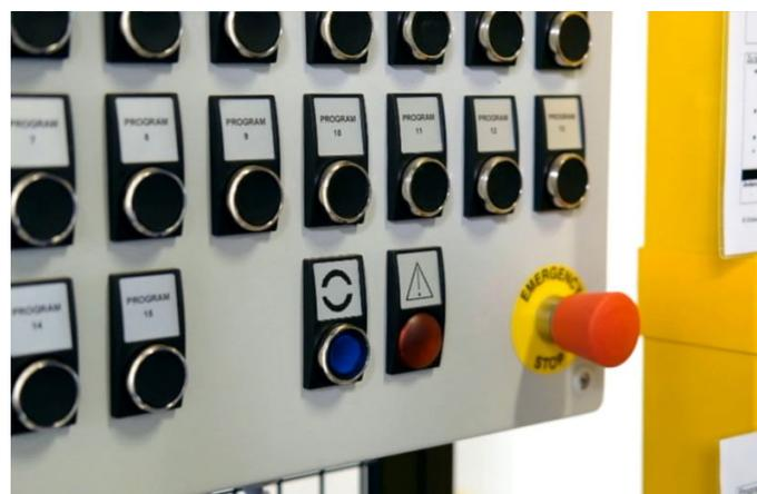
Einfache Programmauswahl bei Palettenaufgabe über Drucktaster
