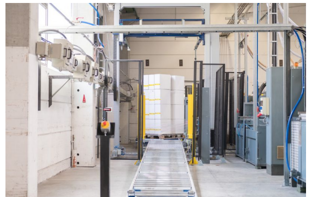
PX 3000 mit automatischem Folienanlege- und Abschneidsystem sowie Entnahme-Rollbahn.
