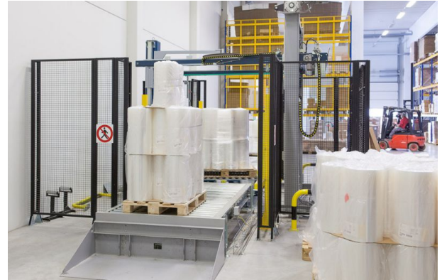
Robuste Palettenaufgabestation mit Anfahrerschutz.
