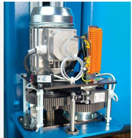
Motorische Folienvordrehensysteme bis 300 % garantieren produktschonenden und sparsamen Folienauftrag
