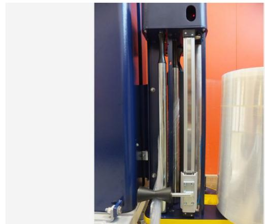
Pneumatische Schnurbildung zur besseren Verbindung der Palette mit der ersten Lage
