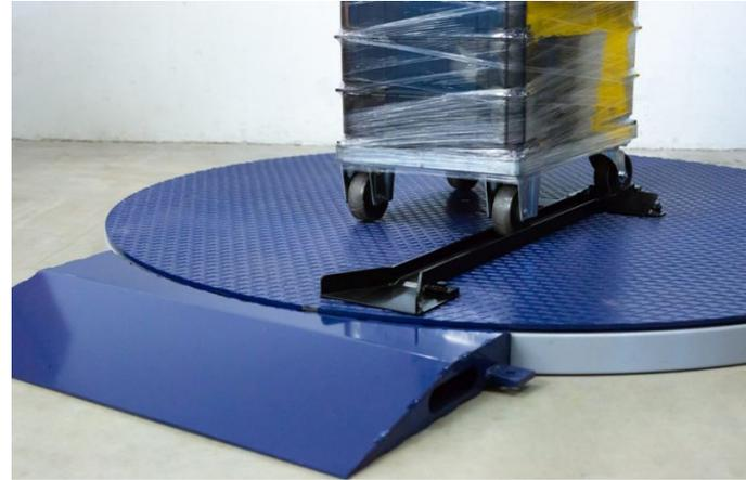
Mechanische Haltevorrichtung mit Arretierhebel für Roll-Container
