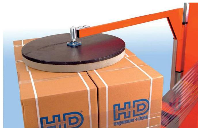
Pneumatischer Andruck-Teller zur Stabilisierung des Palettierguts
