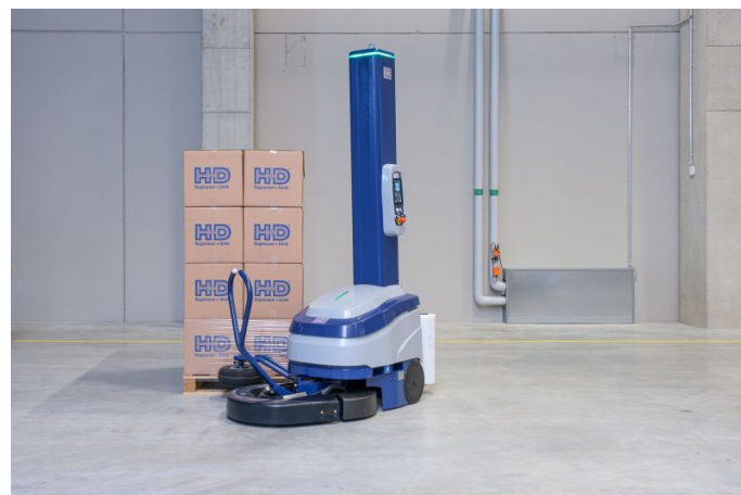
Der Platzbedarf des Palettenwickel-Robots beträgt 1150 mm umlaufend
