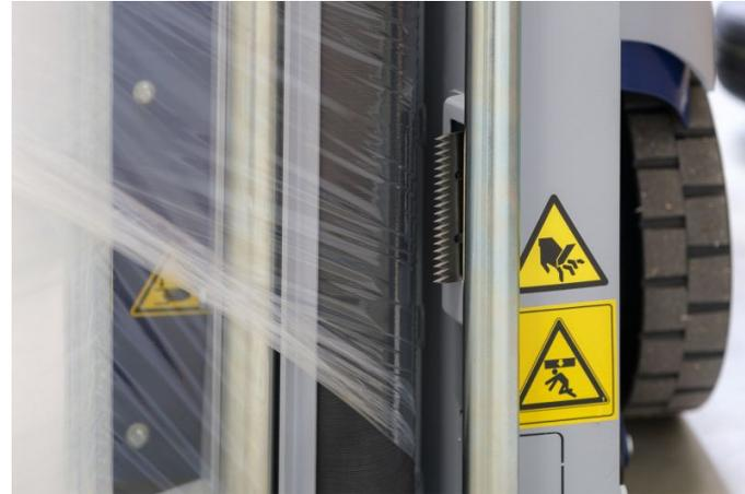
Automatische Trennvorrichtung am Wickelende (optional)
