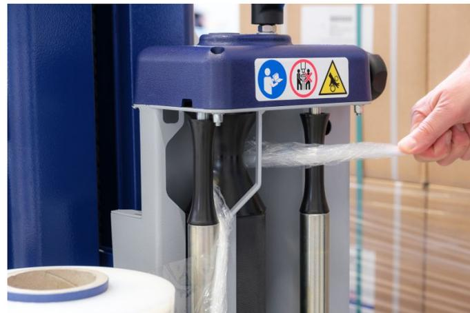
Einfaches Einlegen der Stretchfolie bei Rollenwechsel
