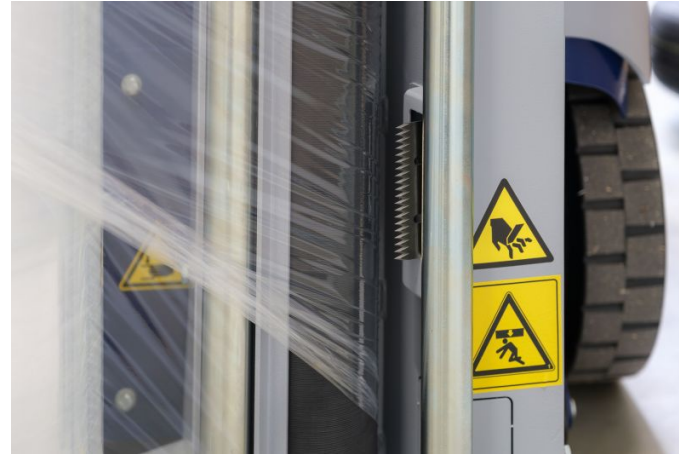
Automatische Trennvorrichtung am Wickelende (optional)
