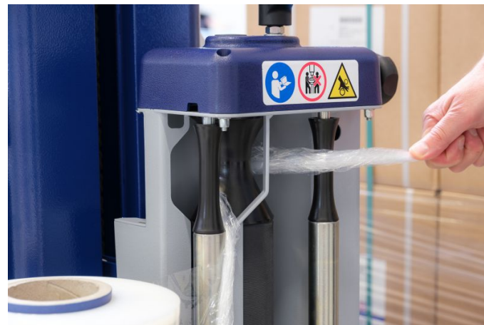
Einfaches Einlegen der Stretchfolie bei Rollenwechsel
