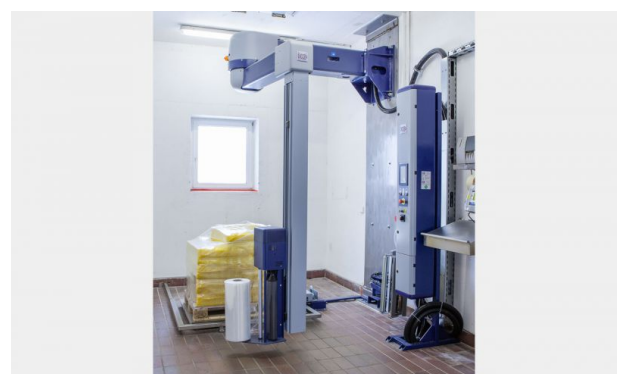
Schonende Palettensicherung durch sanften Lauf des Dreharms
