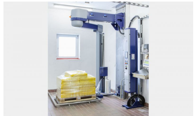
Platzsparende Wandmontage des Dreharms mit separatem Schaltschrank
