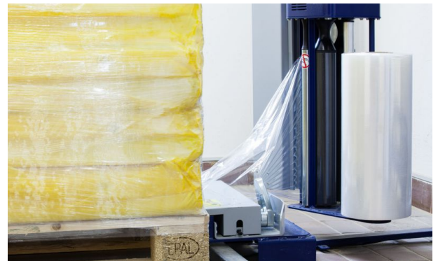
Motorisches Folienvordehnsystem für schonendes Wickeln und hohe Folienspannis
