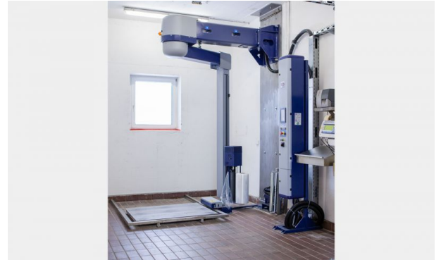
PX 2500-R Dreharmwickler mit optionaler Bodenwaage
