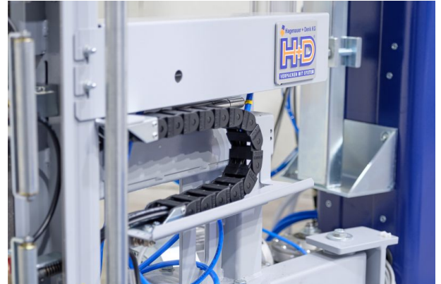
Die Trennvorrichtung wird über Zylinder an die Palette gefahren
