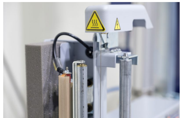
Die Folie wird über teflonbeschichtete Heizelemente getrennt und angesiegelt
