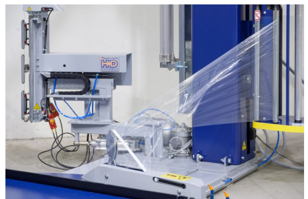
Thermische Folientrennvorrichtung über Schwenkarm
