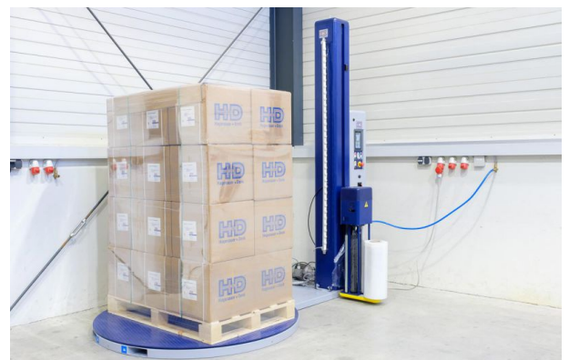
Palettenwickler mit elektrostatischer Entladung über Ionisierungsstab
