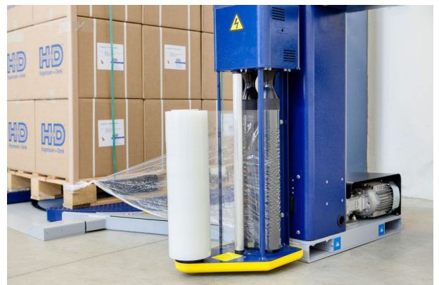
Folienschlitten mit motorischem Vordehnssystem bis 300%
