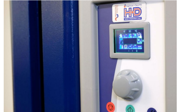
Multi-Color-Display mit Multifunktionsrad für die komfortable Einstellung aller Parameter
