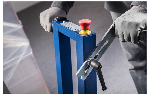
Flexibel einstellbarer Schiebe-Griff für gute Ergonomie
