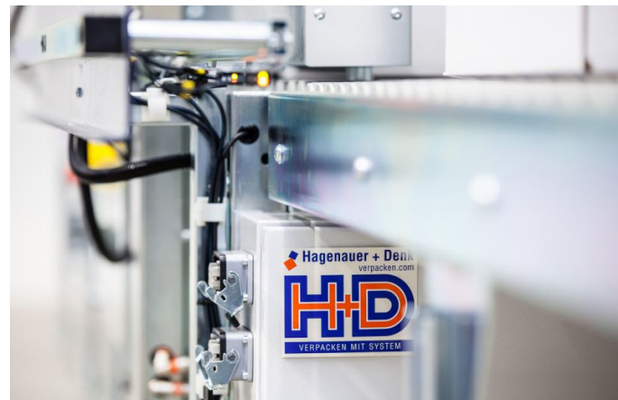
Über Sensorik wird die Kartonposition erkannt und der Faltvorgang gestartet
