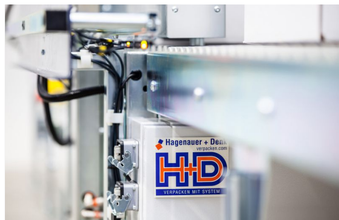
Über Sensorik wird die Kartonposition erkannt und der Falvorgang gestartet
