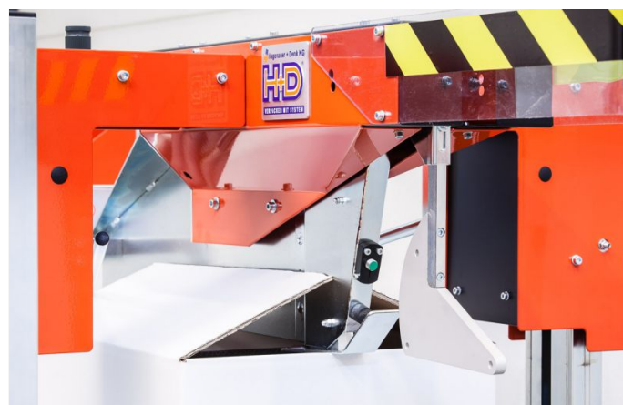
Je nach Kartontyp kann der Einfaltmechanismus angepasst werden (z.B. für geteilte Stirnlaschen)
