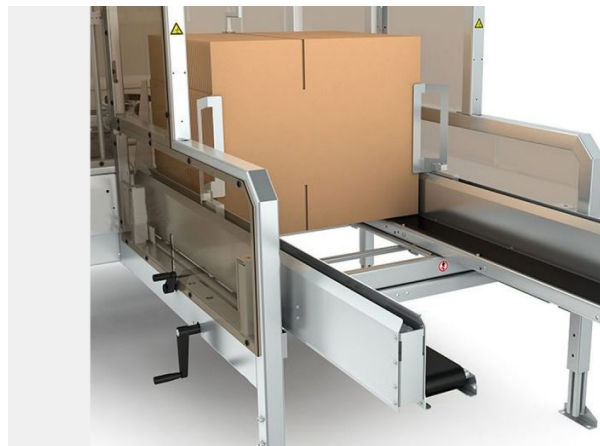
Das motorische Kartonmagazin kann während des Betriebs befüllt werden
