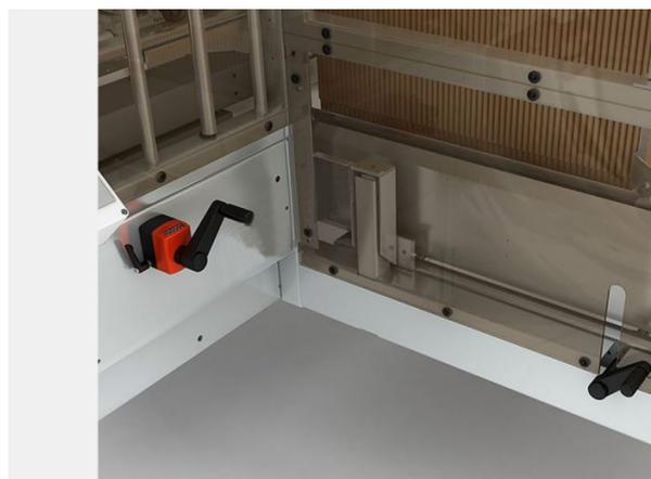
Einfache Formatumstellung mittels Kurbel und Mess-Skala
