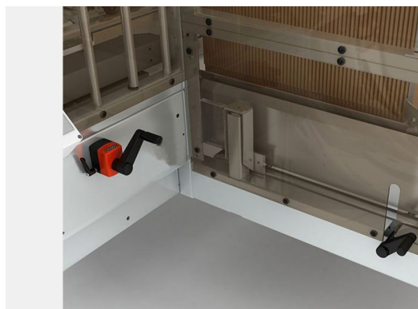
Einfache Formatumstellung mittels Kurbel und Mess-Skala
