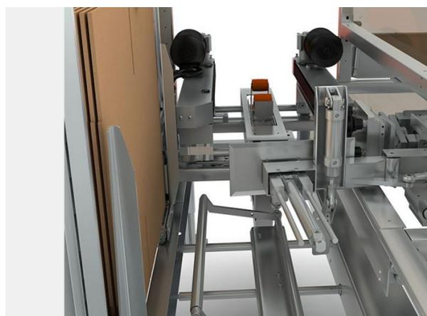
Zuverlässiger Auffaltmechanismus mit anschließendem Bodenverschluss
