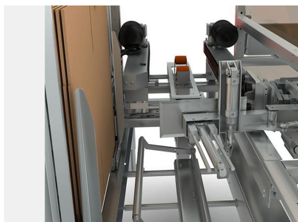
Zuverlässiger Auffaltmechanismus mit anschließendem Bodenverschluss
